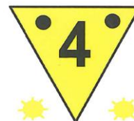
Panneau temporaire, associé pour observation de nuit à deux feux jaunes clignotants
