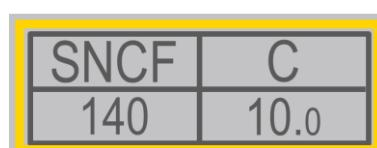
Wagon autorisé à circuler sur le système ferroviaire à la **vitesse maximale de 140 km/h** avec la charge maximale indiquée sous la lettre C
