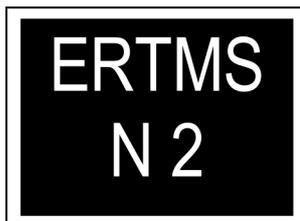
Ce tableau indique au conducteur le point de transition de type de signalisation de cabine. Le conducteur d'un train équipé ETCS cesse d'appliquer les règles de circulation prévues par le présent document et se conforme aux règles de circulation ETCS Niveau 2 dès l'apparition d'une indication donnée par la signalisation de cabine ETCS.
