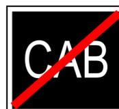
Un tableau « CAB » barré d'un trait rouge ou provisoirement « Fin TGV », à lettres blanches sur fond noir indique que la circulation va sortir d'une ligne à signalisation de cabine.
