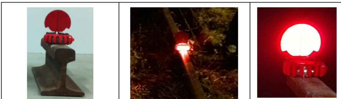
Ce SAM doit être placé sur la file gauche de la voie dans le sens de la circulation (disposition inverse sur les sections de ligne à double voie où la circulation se fait normalement à droite).
