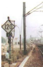
Exemple de TIV de rappel mécanique mobile, de forme carrée, à chiffres blancs sur fond noir, en position de fermeture :
