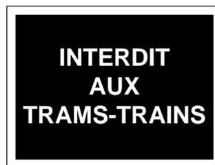
Ce tableau impose l'arrêt. Le conducteur arrêté devant ce tableau doit entrer en contact avec l'agent du service chargé de la gestion des circulations et solliciter des instructions.
