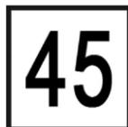
Le signal avancé commande au conducteur de ne pas dépasser la vitesse, indiquée en km/h, au plus tard au droit de l'écran, dans le cas d'une vitesse de ligne décroissante.
