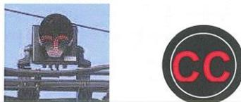
Il commande l'arrêt de la circulation avant le signal.
