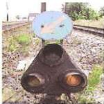
Pour les signaux implantés au ras du sol, le disque est placé au-dessus du signal.
