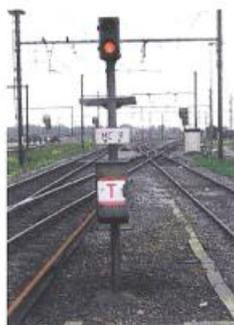
Exemple de signal d'arrêt lumineux simplifié (desservi) sur mât
