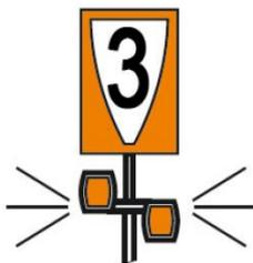
A partir du signal d'exécution correspondant, la vitesse en km/h ne doit pas dépasser la valeur indiquée par le nombre X10 (30km/h dans ce cas).
