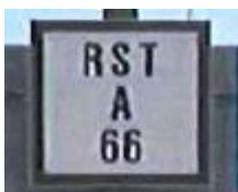
Le tableau repère RF 20 est constitué d'un tableau de forme carrée blanc avec liseré noir. Il indique l'endroit à partir duquel il y a lieu de changer le canal et/ou le mode d'exploitation de la radio sol-train.
