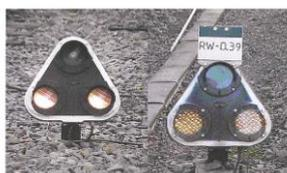
En position de fermeture, le petit signal d'arrêt lumineux présente deux feux blancs sur une ligne horizontale.
