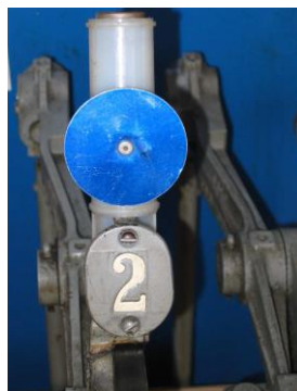
Figure 10 : Exemple de dispositif spécial d'attention (DSA) utilisé par SNCF Réseau
