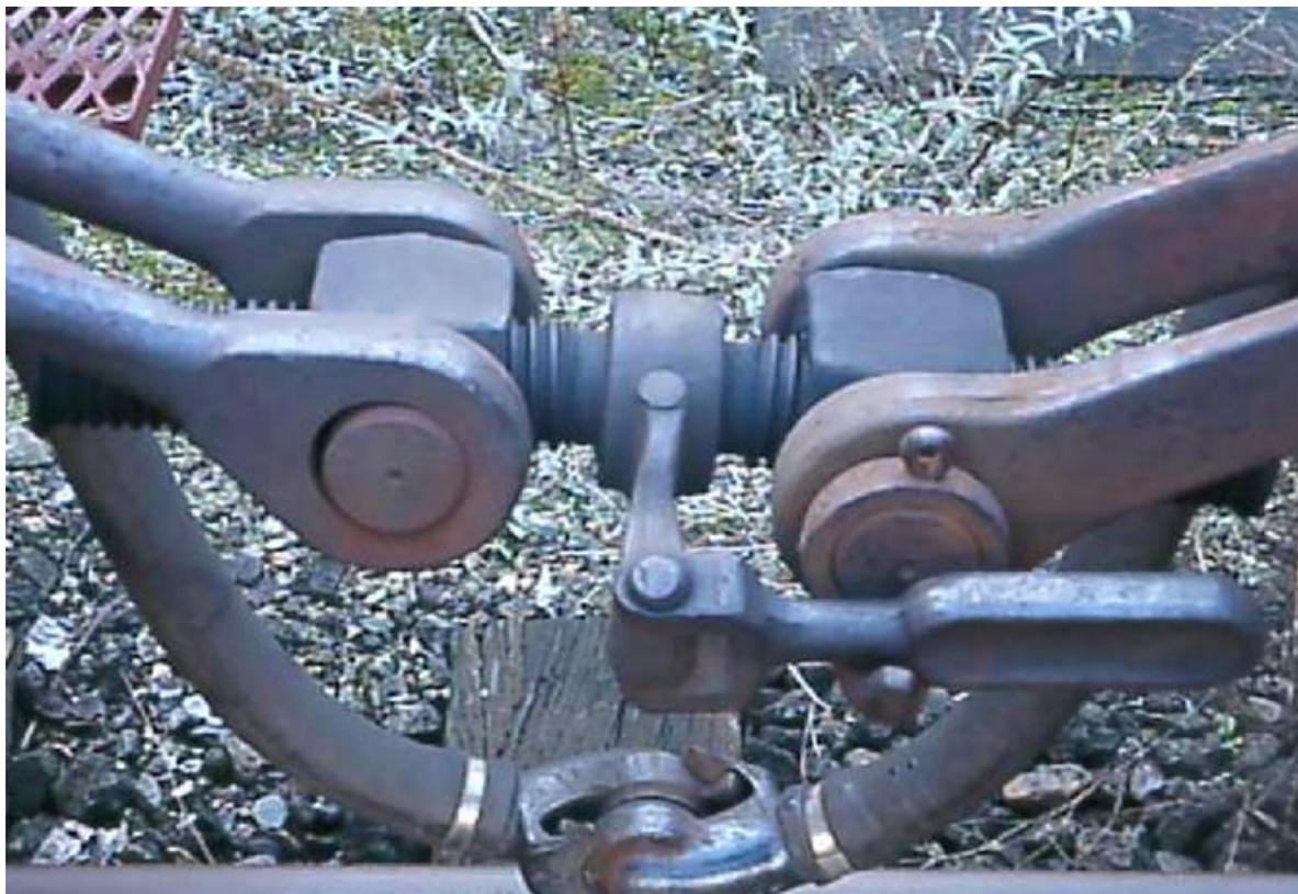
**Exemple d'un ensemble constitué de la chape d'attelage, de la vis (réglée à 2 filets), de la manivelle et de la manille mobile**
