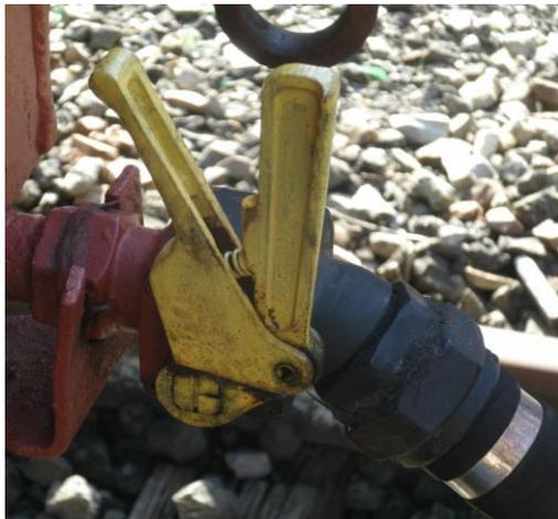
Exemple de robinet d'arrêt (poignée avec enclenchement) en position « fermé ».
