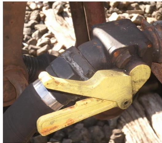
Exemple de robinet d'arrêt (poignée avec enclenchement) en position « ouvert ».
