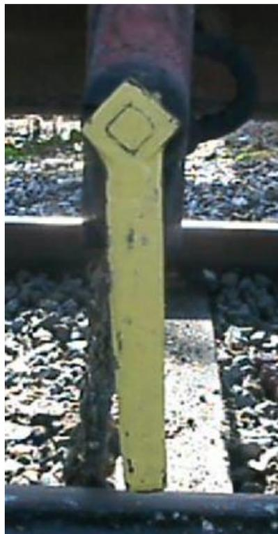
Exemple de robinet d'isolement
