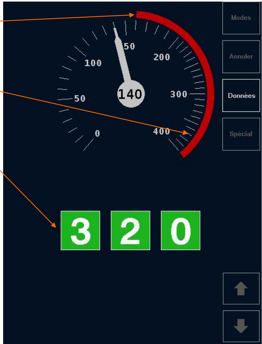
Figure 7-2: Affichage TVM avec performances dégradées de freinage
